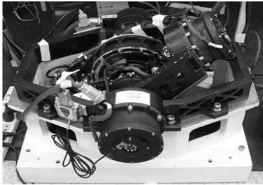
图 11 双框架控制力矩陀螺实验系统
